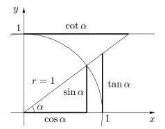
Durch diese Betrachtungen am Einheitskreis werden vier Funktionen definiert.
