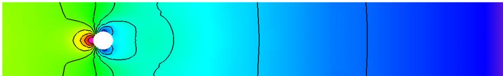
Abbildung 5.6: Visualisierung der Druckverteilung mit Konturlinien in der zentralen Schnittebene durch den Strömungskanal, Oberflächentriangulierung T64
