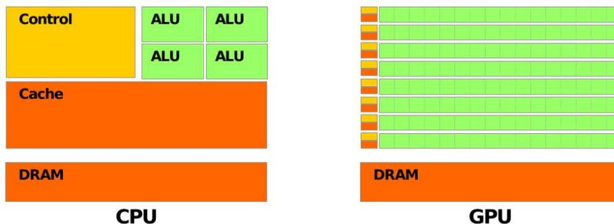
Abbildung 2.7: Architektur einer Multicore-CPU und einer GPU [NVIDIA]
