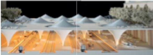
Modell des geplanten Stuttgarter Hauptbahnhofs (Fertigstellung vor. 2013). Der Architektur zugrunde liegen periodische Minimalflächen.
